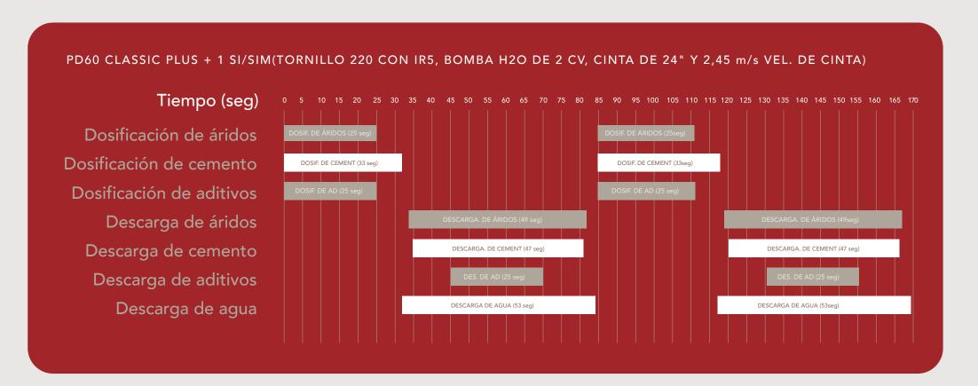
CICLO DE TRABAJO 1.5m3: 85 seg.- PRODUCCION NOMINAL: 64m3/hs. CARGA DE 6m3: 5min 40seg. - CARGA 9m3: 8min 30seg.
