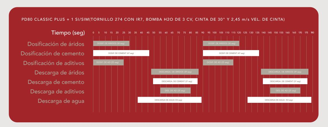
CICLO DE TRABAJO 2m3: 90 seg- PRODUCCION NOMINAL: 80m3/hs. CARGA DE 8m3: 6min- CARGA DE 10m3: 7min 30 seg.
