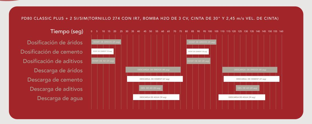
CICLO DE TRABAJO 2m3: 80seg - PRODUCCION NOMINAL: 90m3/hs. CARGA DE 8m3: 5min 20 seg - CARGA DE 10 m3 : 6 min 40 seg.
