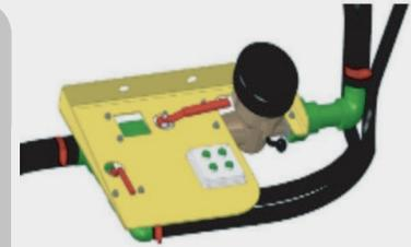
2. Desacoplar tuerca giratoria: con una llave fijar la cañería de pvc procurando no lastimar la válvula y con otra llave se gira la tuerca giratoria, desajustar totalmente. Procurar no perder el suplemento caudalímetro (aro metálico que sujeta sello oring).
