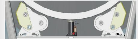
3. Levantar el tambor accionando el gato hidráulico hasta que la pista rodadura se separe 10-15 mm de los rodillos, no más de esa altura porque podría dañar el reductor. Asegurar dicha altura colocando trabas de seguridad.
