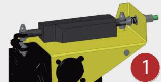
2. Ubicar y desconectar la ficha de conexión del actuador lineal (1), la misma debería estar aislada con un termocontraible. Posteriormente desmonte el actuador lineal. (Remitirse a la ficha de dicho repuesto.)
