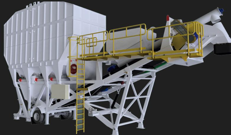
**Circuito de Agua**, compuesto por una bomba de agua de 3 hp/ 3 hp/ 5,5 hp/ 10 hp, filtros, cañerías y caudalímetro inductivo de 2" / 2" / 2" / 3" necesarias para la dosificación e incorporación de agua. Tanque de agua de 1750 lts de capacidad con flotante de corte eléctrico.
