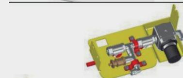
4. Fijar presurizado nuevo con las bridas omega al soporte, verificar alineación del presurizado con el soporte. Colocar palancas de la llave de paso, contador de vueltas y colocar el soporte en la MTI.
