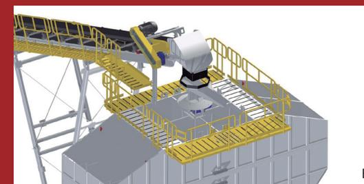
**A) Pantalón Neumático:** para tolvas de hasta 4 áridos, construido en acero SAE 1045 de 4,75 mm de espesor y 240 Brinell de dureza promedio, con placas antidesgaste del mismo material.
