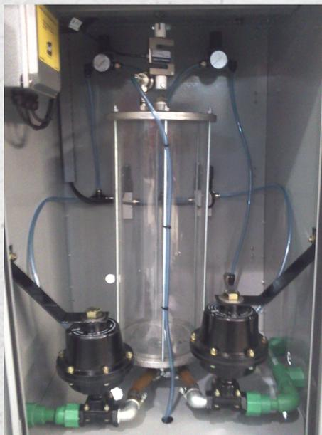
**DOSIFICADOR DE ADITIVOS DA 20** (opcional) capaz de dosificar hasta 2 aditivos por suma de los mismo, en un vaso de 22 lts total. Sistema presurizado de descarga automática por el fondo del vaso a presión. Carga individual con 3 bombas centrífugas independientes. 2 para Aditivos y 1 para Lavado.
