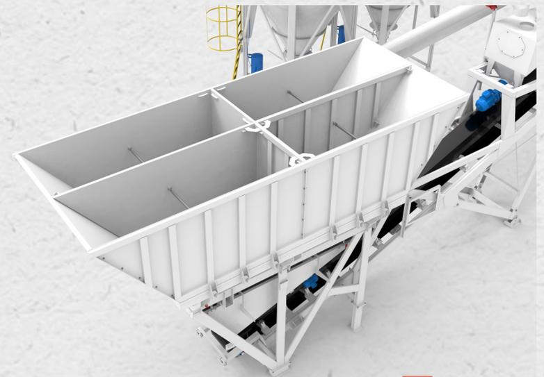
**Báscula dosificadora de áridos** para pesaje por suma de los mismos, montada sobre cuatro celdas de carga de 2500 lbs (4 × 2500 lbs) dimensionada para una capacidad máxima de 3100 Kgs de áridos en total. Descarga por el fondo mediante una compuerta de apertura regulable y comandada por un cilindro neumático de Ø63 x 100 mm de carrera marca FESTO y un vibrador eléctrico.
