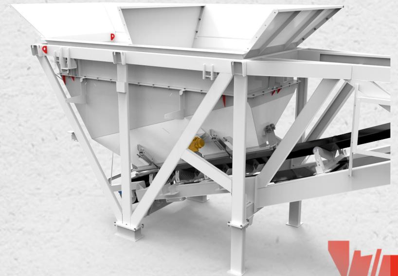
**Cinta transportadora** de 24" de ancho, de goma lisa de dos telas de nylon. Accionada por reductor pendular a engranajes de Cr-Ni, Cementados y Templados, marca INDUMIX, modelo IR 16 105 de nuestra fabricación y motor eléctrico marca ADAS de 12.5 HP a 1450 rpm, 100% blindado. Tolva Final de Cinta de descarga construida en acero SAE 1045 de 3/16" (4.75 mm) de espesor y 240 Brinell de dureza promedio.
