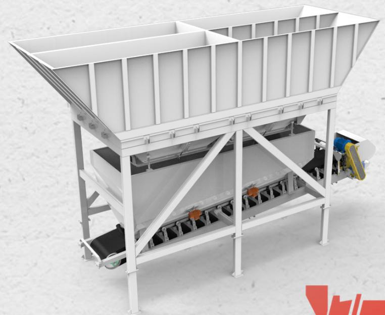
telas de nylon. Accionada por un reductor pendular, con rodamiento antirretorno, a engranajes de Cr-Ni, Cementados y Templados, marca INDUMIX, modelo IR 16 105 de nuestra fabricación y motor eléctrico marca ADAS de 10 HP a 1450 rpm, 100% blindado. Cabezal motriz engomados. Tolva completa realizada en chapa espesor 4,76mm. Vibrador marca ADAS.
